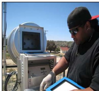
Un técnico de Campo EPA cambia un filtro en el Monitor PM<sub>10</sub> monitor cerca de las Oficinas tribales, *Campo Band del Kumeyaay Nación, Campo, CA*
