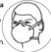
**Respirador facial a media cara** pueden ser usado para protección contra la mayoría de los vapores, gases ácidos, polvo o humo de soldaduras. Cartuchos/filtros deben hacer juego con los contaminantes y ser cambiados periodicamente.
