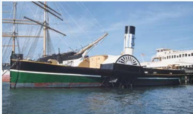
*Eppleton Hall*: remolcador de acero; 30,6 metros. Construido en 1914, South Shields, Inglaterra.
