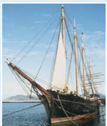
C.A.セイヤー号：3本マストのスクナー；156フィート。1895年、カリフォルニア州フェアヘブンにて建造。
