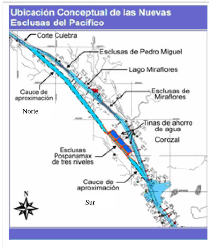
**FIGURA 5-1: EL COMPLEJO DE ESCLUSAS DEL PACÍFICO SE CONSTRUIRÁ AL SUR-OESTE DE LAS ESCLUSAS DE MIRAFLORES CON UN NUEVO CAUCE DE APROXIMACIÓN QUE LO CONECTARÁ CON EL CORTE CULEBRA. FUENTE: ACP – PLAN MAESTRO DEL CANAL DE PANAMÁ, ABRIL 2006.**
