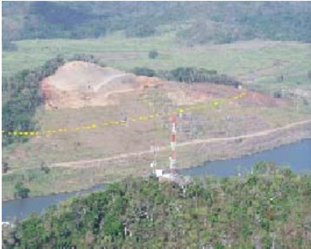
*Vista en Planta del Corte del Cerro en el PAC 1 (línea roja marcada en el plano) y ubicación del futuro Canal de Acceso Pacífico*
