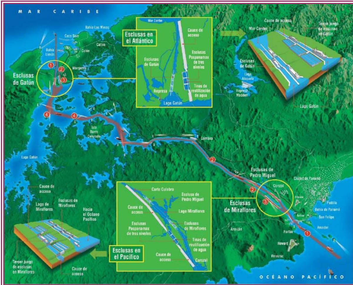
**FIGURA 3-2: COMPONENTES DEL PROGRAMA DE AMPLIACIÓN DEL CANAL DE PANAMÁ. ACP – PLAN MAESTRO DEL CANAL DE PANAMÁ, ABRIL 2006.**
