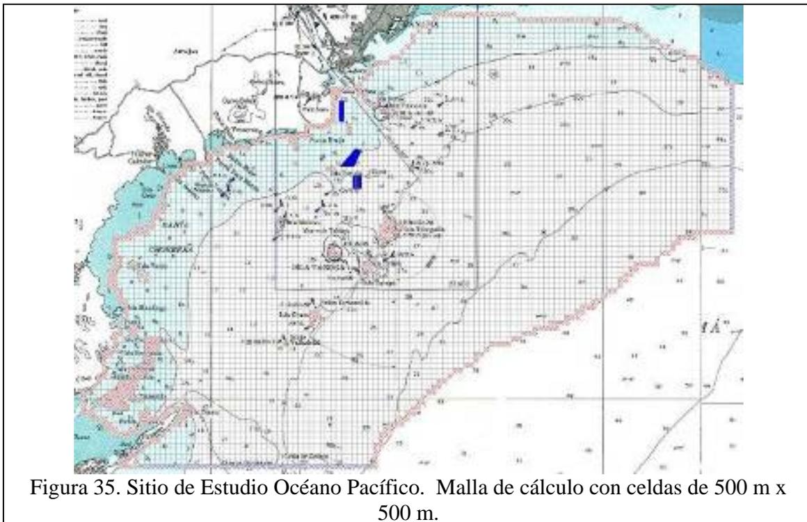
Figura 35. Sitio de Estudio Océano Pacífico. Malla de cálculo con celdas de 500 m x 500 m.
