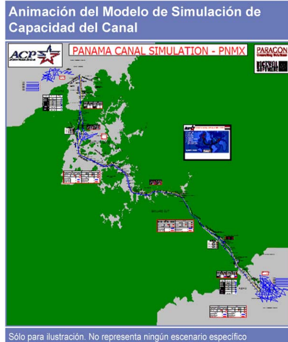
Figura 2-5 Mediante la simulación de los tiempos de navegación y esclusaje y de las reglas y restricciones operativas el modelo de simulación de capacidad del Canal permite evaluar el nivel de servicio que recibirán los clientes del Canal bajo distintos escenarios.
