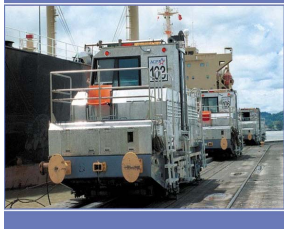
Figura A–23 El Canal cuenta con una flota de 100 locomotoras para el posicionamiento de buques en las cámaras de las esclusas.
