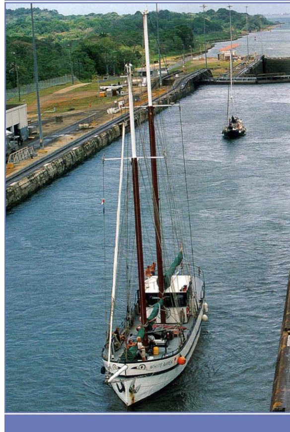
Figura A-46 El esclusaje de pequeñas embarcaciones como yates no requiere del uso de locomotoras ya que su tamaño pequeño permite que se maniobren fácilmente dentro de las cámaras.
