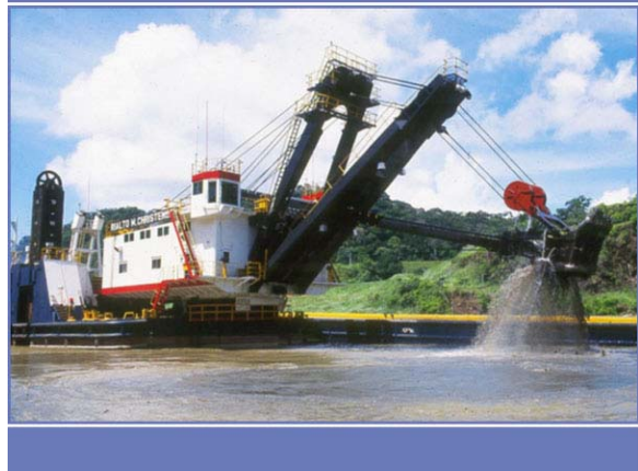
Figura A-34 La draga de cucharón Rialto M. Christensen se utiliza para el dragado de material rocoso sólido.
