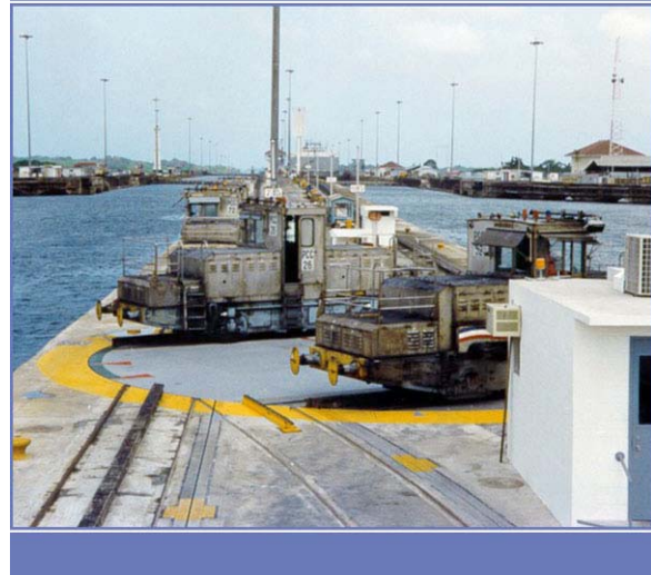
Figura 5-14 Las tornamesas existente en las esclusas de Gatún deberán ser actualizadas para operar en forma continua durante operaciones en modo de carrusel.
