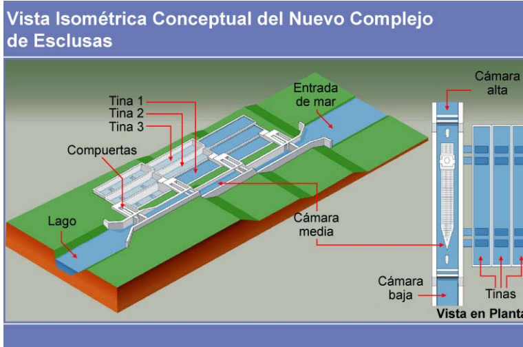
Figura 2 Vista isométrica del complejo de esclusas con sus compuertas y tinas para reutilización de agua. En el dibujo lateral se muestra una vista en planta de una de las cámaras típicas con un buque.
