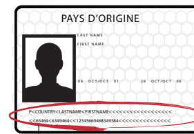
Un passeport lisible en machine comporte deux lignes de texte avec des lettres, des chiffres et des chevrons (<<<<) en bas de la page d'informations, sous la photo du titulaire.
