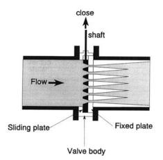
Figure 11. Monovar<sup>TM</sup> Valve
