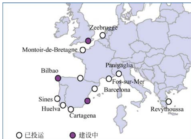
图 45 西欧国家已经运行的和正在建设的液化天然气接收站（1990—2025）
