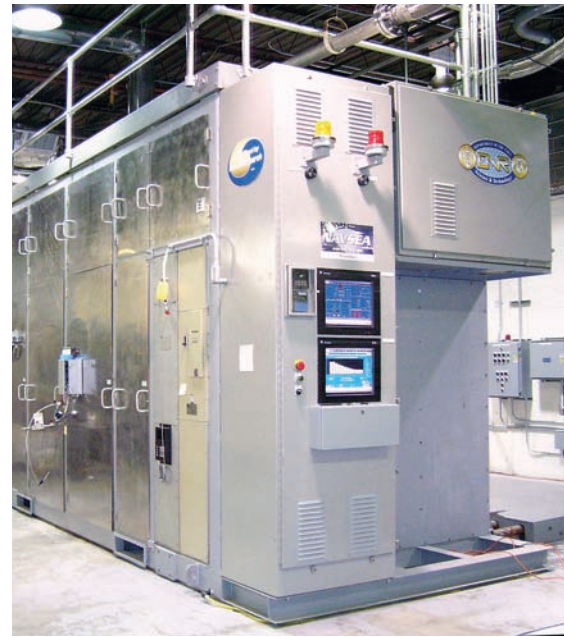
热柜:625溶化碳燃料电池改良装置(电池部分不在图中);可从含高硫的燃料中生产甲烷后提供给燃料电池,这样的能效可高达47~50%。这一装置正由海军研究办公室在陆地上测试,将在2007年在费城安装在海军海上指挥系统上后作进一步测试。
