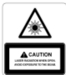
Abbildung 1.: Kundendienst und Warnetiketten Das Etikett ist auf der Rückseite des GenePix 4000A auf dem oberen Teil des Schutzgehäuses befestigt. (Wirkliche Grösse).
