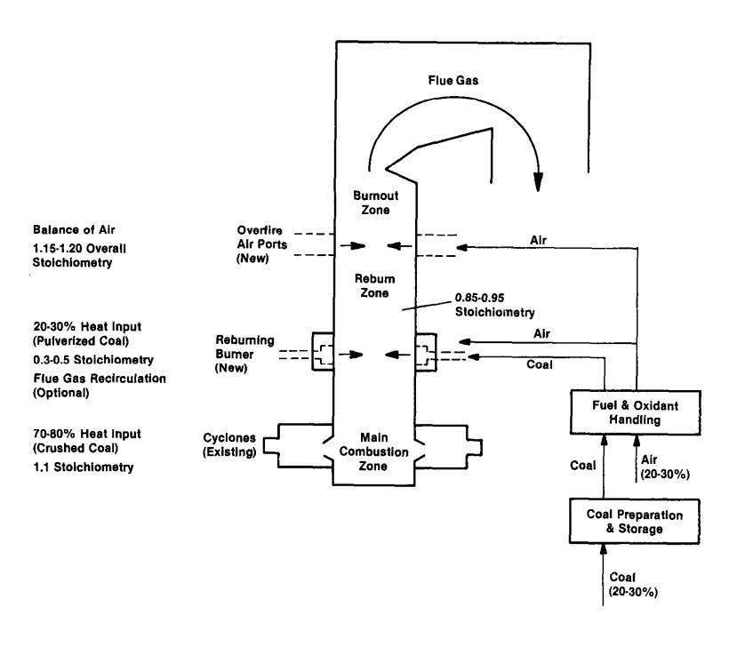
FIGURE 2. B&W COAL REBURNING PROJECT GENERIC SCHEMATIC DIAGRAM.
