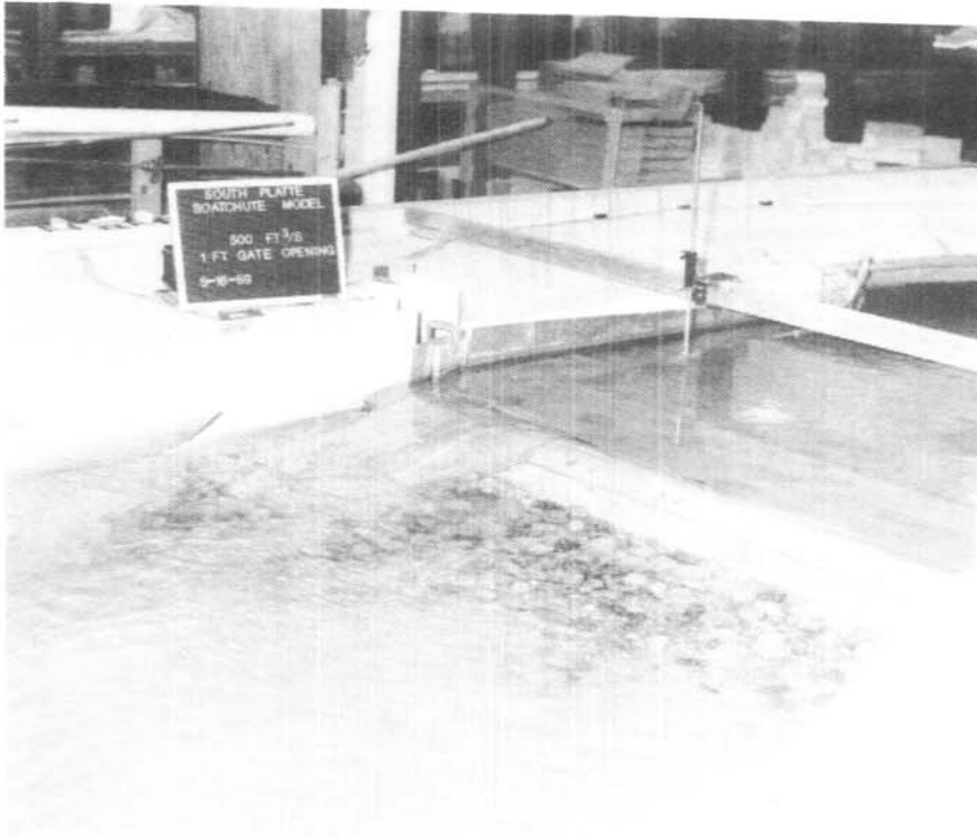
Foto 1.- Modelo hidráulico diseñado y en vías de construcción en el laboratorio de investigaciones en el Denver Federal Center.
