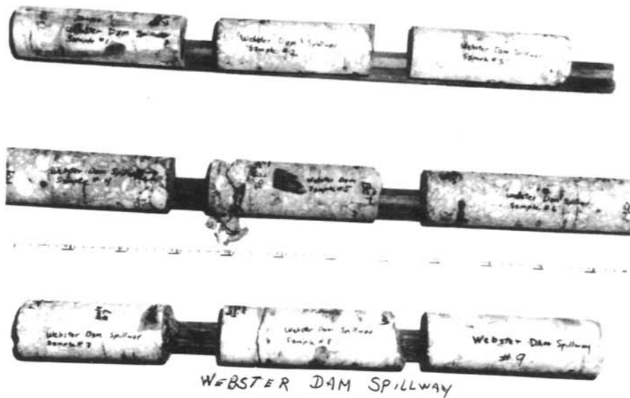
Foto No. 3.- La Presa de Webster. Los núcleos Nos. 1, 5 y 8 de fracturas cerca de la superficie fueron sacados de las lozas de la solera próximas a las zonas de visible deterioro. Los núcleos Nos. 2, 3 y 4 son del centro de las lozas de la solera y parecen ser sanos. El núcleo No. 6, obtenido en la pared de pie, y el No. 7 en la cubierta de la galería, son también sanos. 2/11/72
