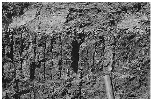
Figura SU-P-5: Estructura Prismática
