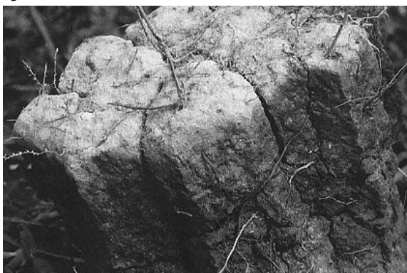
Figura SU-P-2: Estructura Columnar
