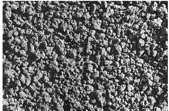
Figura SU-P-3: Estructura Granular
