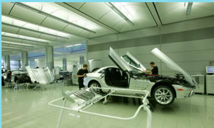
Композиты из углеродного волокна используются для изготовления дверей, капота и кузова автомобиля «Мерседес-Бенц СЛР МакЛарен» на заводе в Англии.
