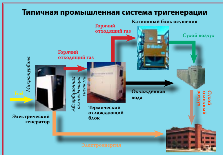
Электрический генератор (микротурбина) выполняет различные энергетические функции внутри здания.
