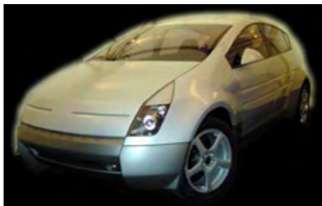
Figure 1 : le prototype de voiture « Revolution », voiture utilitaire de sport en fibre de carbone, de taille moyenne et ultra-légère (860 kg), dont la conception remonte à 2000.
