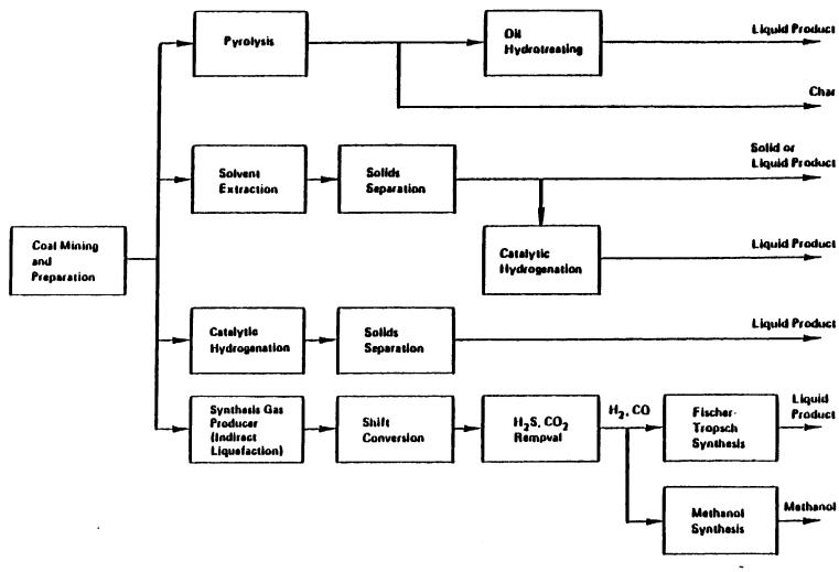
FIGURE XVIII-1. COAL LIQUEFACTION ROUTES (ONLY MAJOR PRODUCTS ARE SHOWN)
