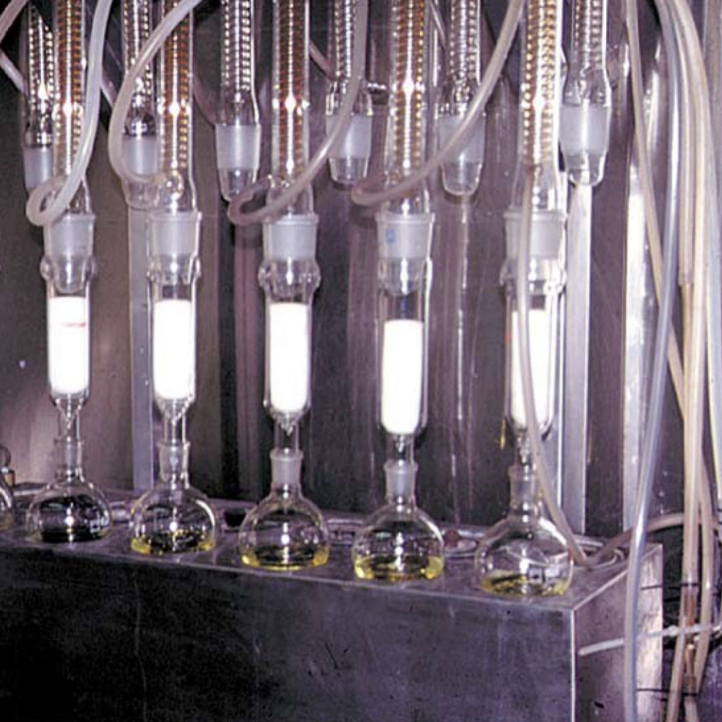
Extracción de aceite de oliva con solvente, utilizando el extractor soxhlet
