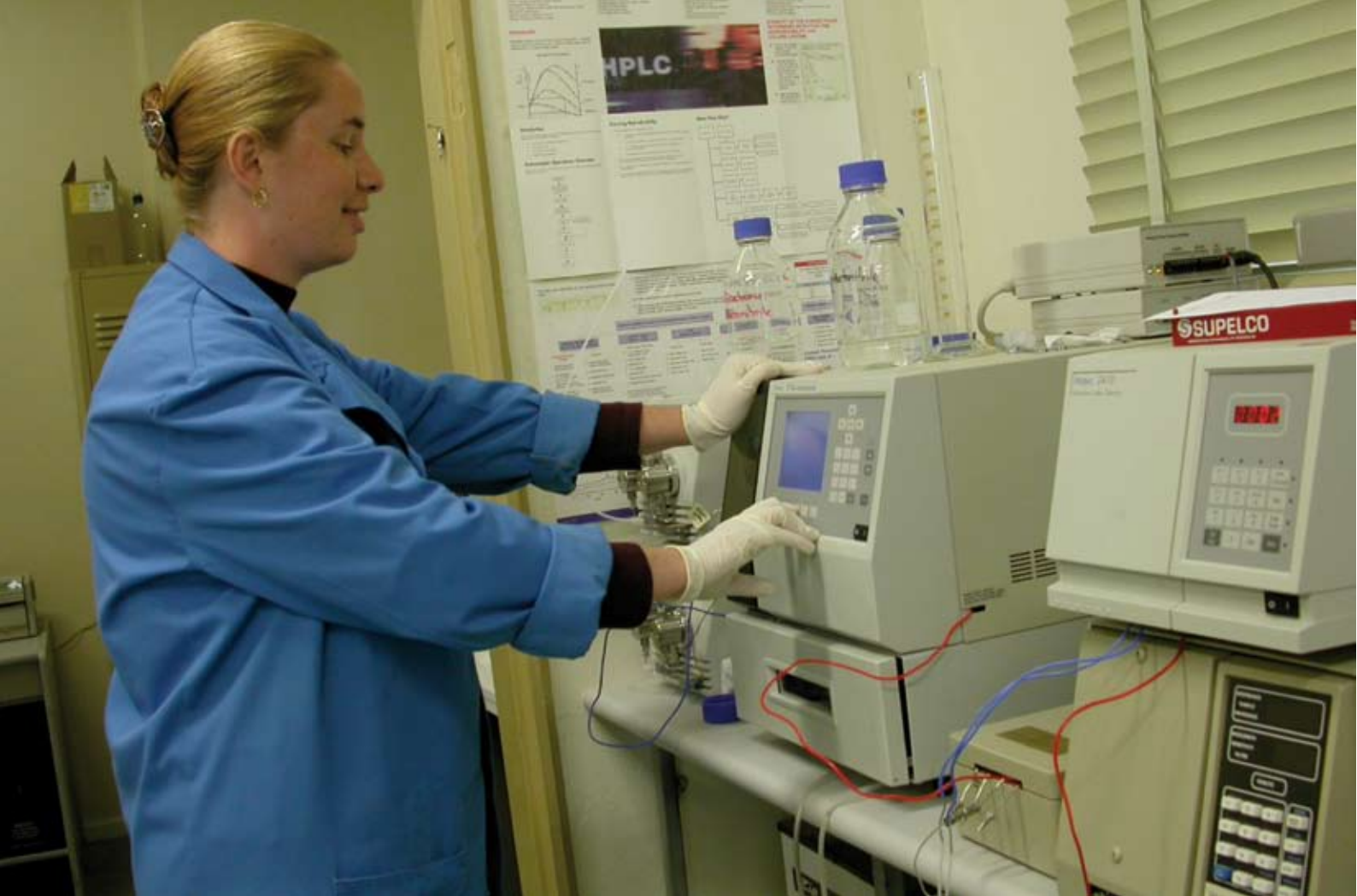
Amanda McFadden, del Ministerio de Industria Primaria de Nueva Gales del Sur, analiza aceite de oliva con cromatografía líquida
