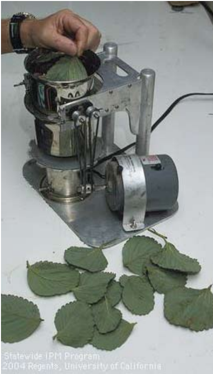
Una máquina de cepillos cepilla los ácaros (arañas) de la superficie de las hojas a una lámina de vidrio rotante que se cubre con una sustancia para atrapar a los ácaros (arañas) para poder contarlos.
