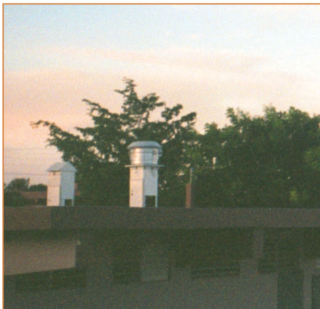
Durante los últimos 3 años, la Junta de Calidad Ambiental de Puerto Rico ha estado midiendo la contaminación atmosférica en dos barrios de Vieques. Esta fotografía muestra un mecanismo de muestreo en Esperanza.
