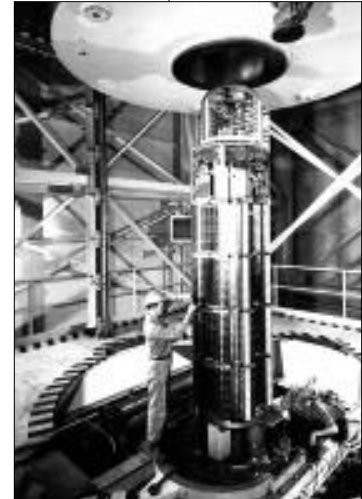
A vertical Van de Graaff accelerator.
