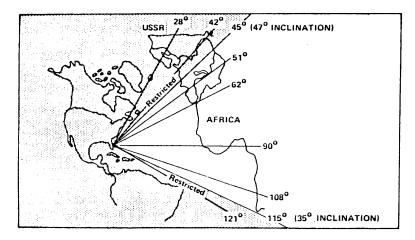
FIGURE 10-9. ETR GEOGRAPHIC LAUNCH AZIMUTH CONSTRAINTS (REF. 7)
