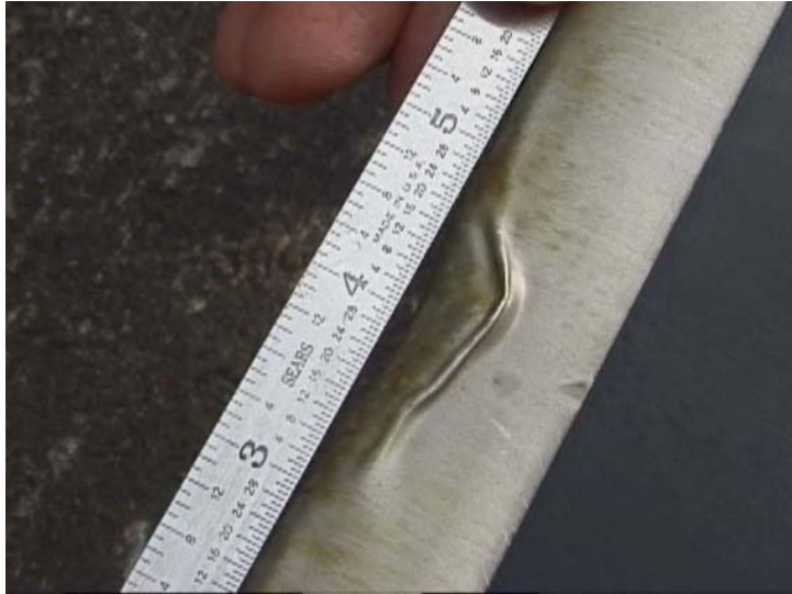
Leading edge damage
