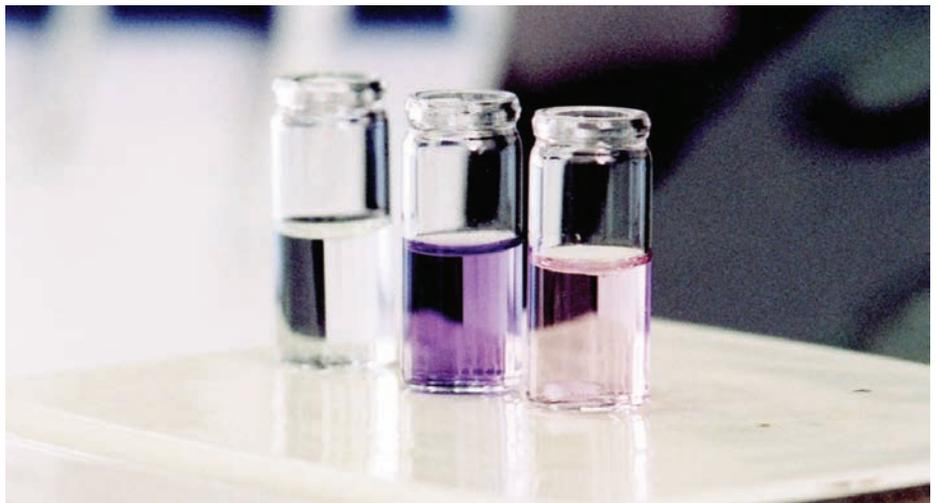
尚在研发中的Fe-TAML: (上图) 科研人员在三个装有清水试管的其中的二个加入纺织染液。(中图) Colin Horwitz在第三瓶含有纺织染液试管中加入Fe-TAML活性物质和过氧化氢。(下图) 催化剂消除了染液, 使其颜色变得清亮。
