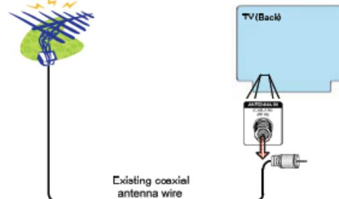
Étape ❷ Brancher le câble coaxial existant à l'emplacement marqué "antenne in (RF)" (Entrée d'antenne) sur le boîtier décodeur.
