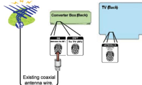
Étape ❸ Prenez le câble coaxial livré avec le boîtier décodeur et brancher un terminal sur le boîtier décodeur à l'emplacement marqué "out to TV (RF)" (sortie vers la TV). Brancher l'autre terminal à l'emplacement indique par "Antenne in (RF)" (Entrée de l'antenne) sur votre poste de télévision.
