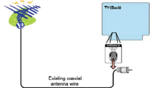
الخطوة 2: أدخل الكبل ذو الموصلين الحالي في منفذ إدخال كبل الهوائي (RF) في جهاز التحويل.
