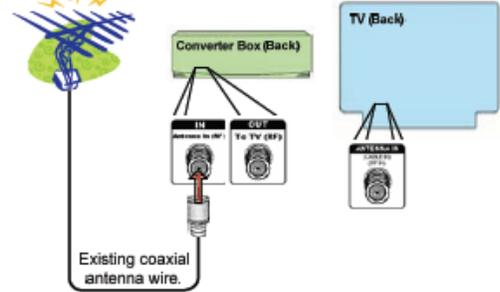
الخطوة 3: باستعمال الكبل ذو الموصلين المزود مع جهاز التحويل، أدخل إحدى النهايتين في منفذ إلى جهاز التلفزيون "Out to TV (RF)" الموجود على جهاز التحويل. أدخل النهاية الأخرى في منفذ إدخال الكبل الهوائي "Antenna in (RF)" على جهاز التلفزيون.
