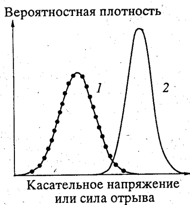
Рис. 1. Перекрывание двух функций вероятностной плотности: 1 – мгновенных касательных напряжений на дне потока; 2 – локального сопротивления почвенных частиц отрыву.
