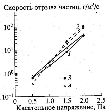
Рис. 2. Измеренная и расчетная скорости отрыва частиц почвы Полдинг (агрегаты размером 1–2 мм) как функция средней величины касательного напряжения на дне потока. 1 – уклон дна 1%; 2 – глубина потока 1 см; 3 – измеренное; 4 – расчетное.
