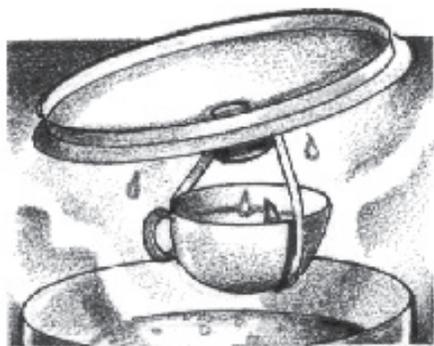
La destilación consiste en hervir el agua y recolectar después sólo el vapor que se condensa. El vapor condensado no contiene sal ni casi ninguna otra impureza. Para destilar, llene una olla de agua hasta la mitad. Ate una taza a la tapa de la olla para que cuelgue en posición normal cuando la tapa de la olla está al revés (asegúrese de que la taza no esté colgando dentro del agua) y deje hervir el agua durante 20 minutos. El agua que gotea de la tapa a la taza está destilada.
