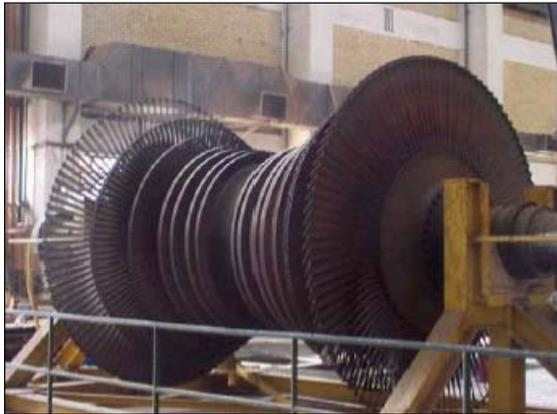
الدوار المحرك لمشروع الطاقة الكهربائية في الطريق ليتم اعادة بنائه.
