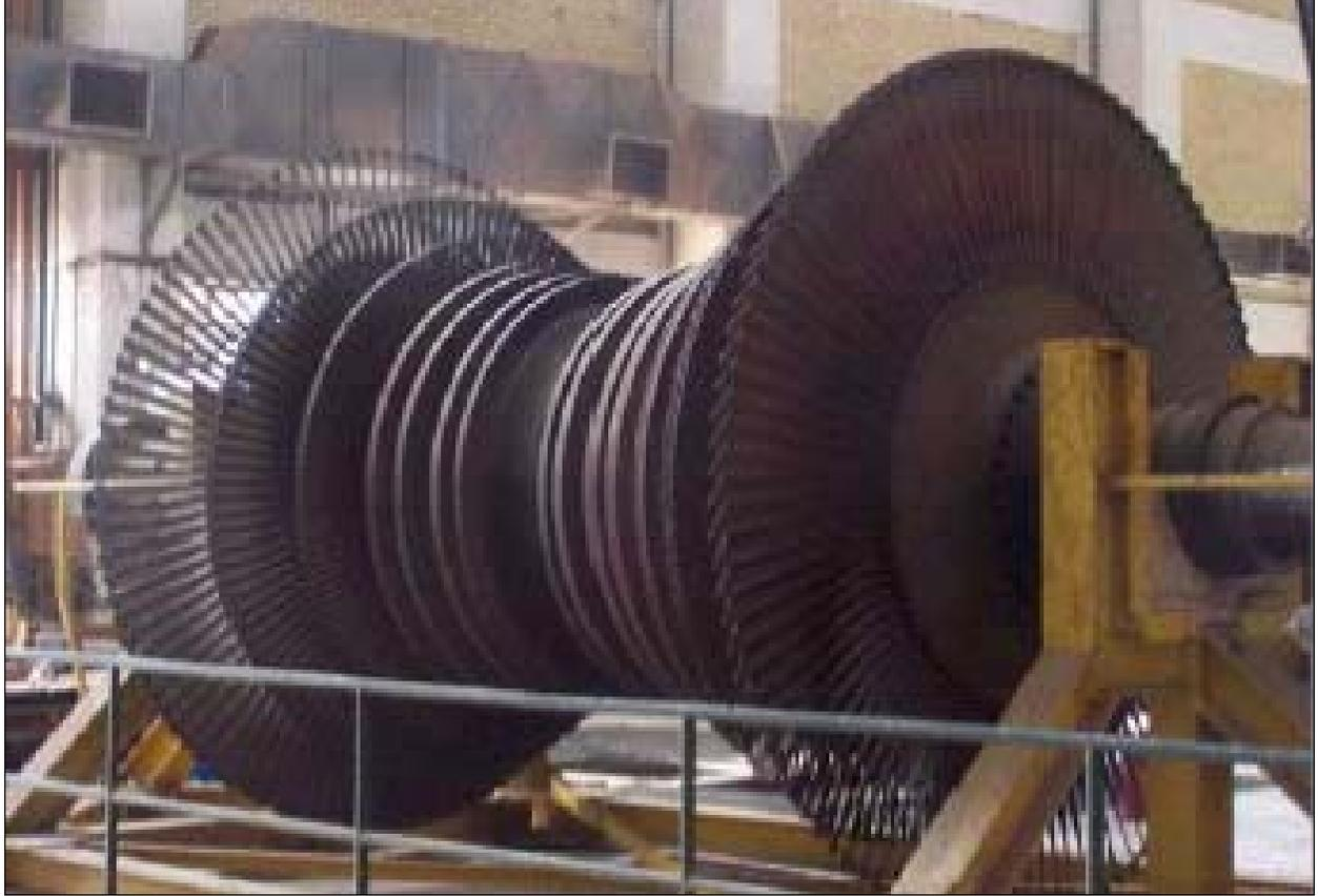
في الاعلى : الدوار المحرك لمشروع الطاقة الكهربائية في الطريق ليتم اعادة بنائه .
