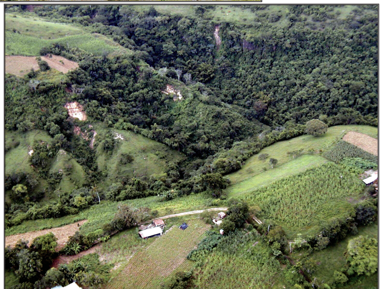
Figura 12. Grietas de los desprendimientos de tierra provocados por el sismo del 13 de febrero de 2001, al oeste de San Lorenzo. Al igual que los desprendimientos de tierra provocados por el huracán Mitch, fueron pocos los daños de gravedad provocados por estos desprendimientos; sin embargo los continuos desprendimientos que se han presentado indican que estas pendientes son muy susceptibles a los desprendimientos de tierra.
