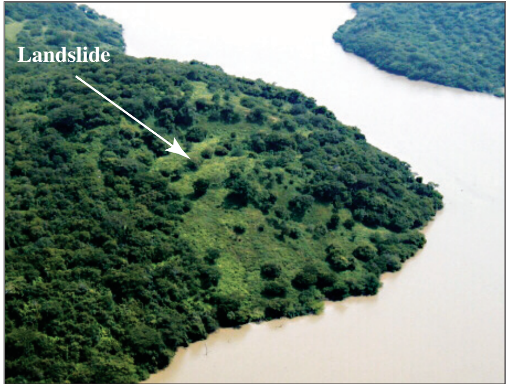
Figura 16. Gran desprendimiento de tierra inactivo previo al huracán, en la ribera del Embalse 15 de septiembre. En caso de reactivarse, un desprendimiento de tierra como éste podría bloquear parcialmente la presa; sin embargo está lo bastante corriente arriba de la presa como para no interferir con el funcionamiento de la presa o el de las instalaciones hidroeléctricas.
