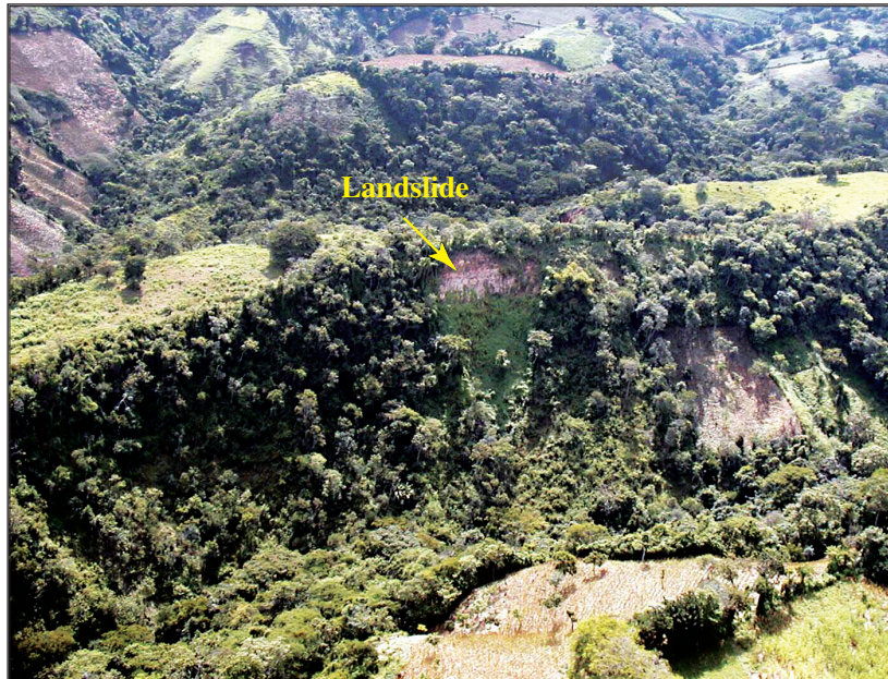
Figura 12. Grietas de los desprendimientos de tierra provocados por el sismo del 13 de febrero de 2001, al oeste de San Lorenzo. Al igual que los desprendimientos de tierra provocados por el huracán Mitch, fueron pocos los daños de gravedad provocados por estos desprendimientos; sin embargo los continuos desprendimientos que se han presentado indican que estas pendientes son muy susceptibles a los desprendimientos de tierra.
