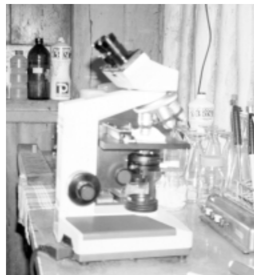
Figura 1.4. Un pequeño microscopio de laboratorio requiere sólo un uso moderado de luz de 30 vatios. Es el Equipo esencial para el diagnóstico en el campo.
