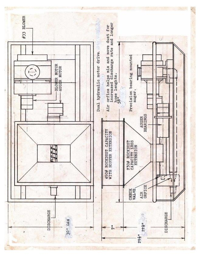
SPECIFICATIONS FOR: MODEL HARD - HYDRAULIC AUGER ROCKDUSTER
