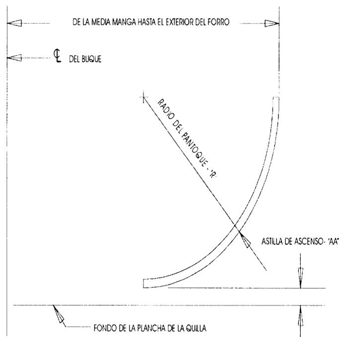
NOTA: En un esclusaje descentrado en que el buque toque el muro de la esclusa, la curvatura del pantoque debe quedar franca de los taludes de las cámaras de las esclusas en el punto más crítico, tal como se ilustra en la Tabla de Límites de Calado en este anexo.
