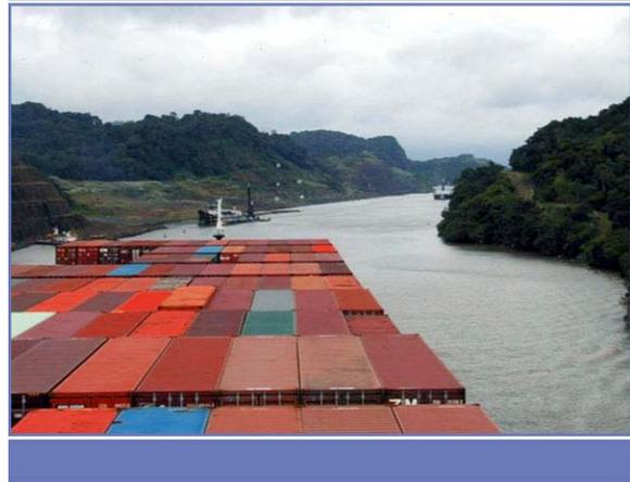
Figura A-49 Buque entrando al Corte con visibilidad reducida por contenedores
