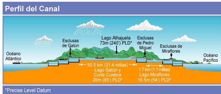
**Figura A-5** Alturas y longitudes de algunos componentes importantes del Canal.
