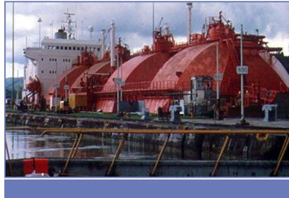
Figura A-59 Buque con tanques de gas líquido
