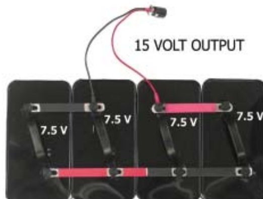
15 VOLT BATTERY CONFIGURATION
