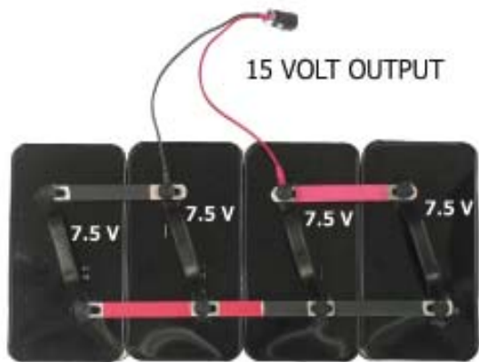
15 VOLT BATTERY CONFIGURATION
