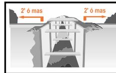
Un medio seguro de salida tiene que ser colocado en una trinchera a un máximo de 25 pies de los trabajadores.
