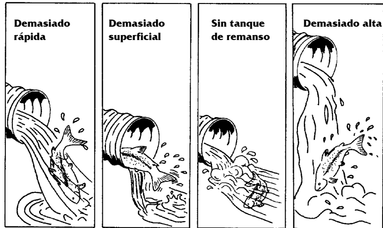
Figura 2.2b Alcantarillas mal diseñadas o instaladas, con “barreras para peces” que evitan el paso de peces. (Redibujado de Evans and Johnston, 1980.)
