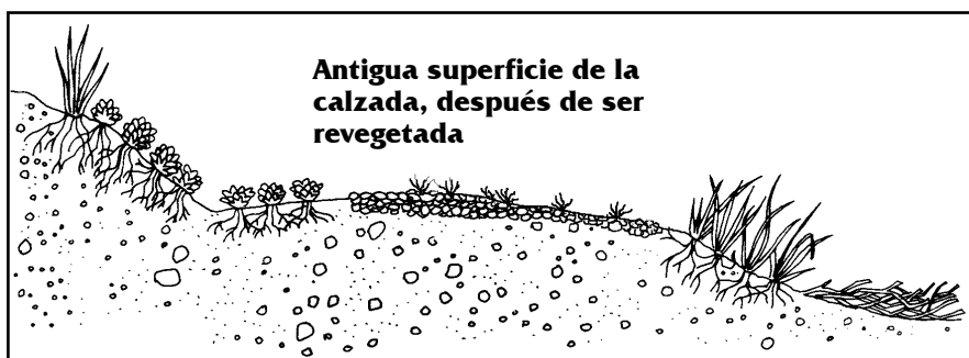
c. Puesta fuera de servicio - Cierre permanente del camino mediante escarificación de la superficie y siembra de semillas para reforestación, pero manteniendo la mayor parte de la plantilla del camino (geometría).
