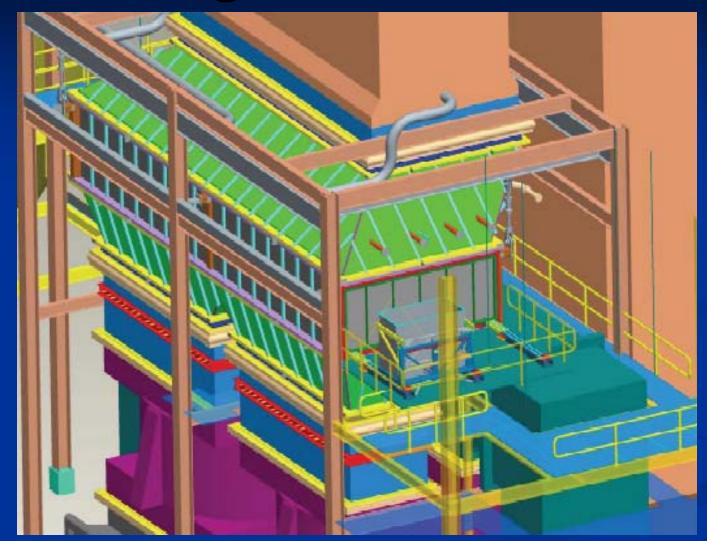
**Bed Depth** ~ 1.3 m  $\underline{SO_2} \rightarrow \underline{SO_3}$ < 1.0 % **NH<sub>3</sub> Slip** < 2 ppmv <u>NO<sub>x</sub> Removal</u>
