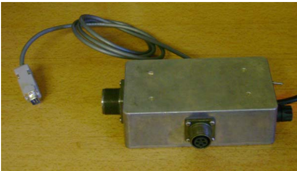
AL controller box
