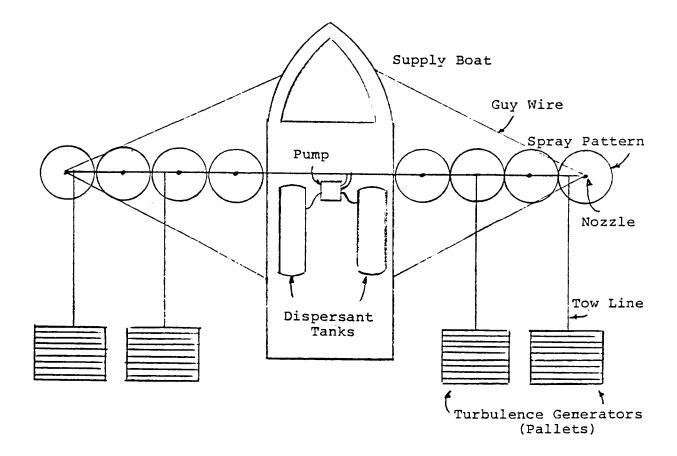
FIGURE 4.9 DISPERSANT SYSTEM - VESSEL APPROACH
