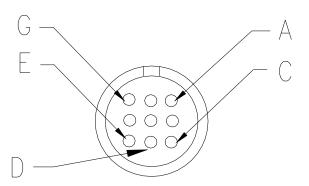
CONNECTOR PART NO.: MS3102A22-20P MATING CONNECTOR: MS3106A22-20S
