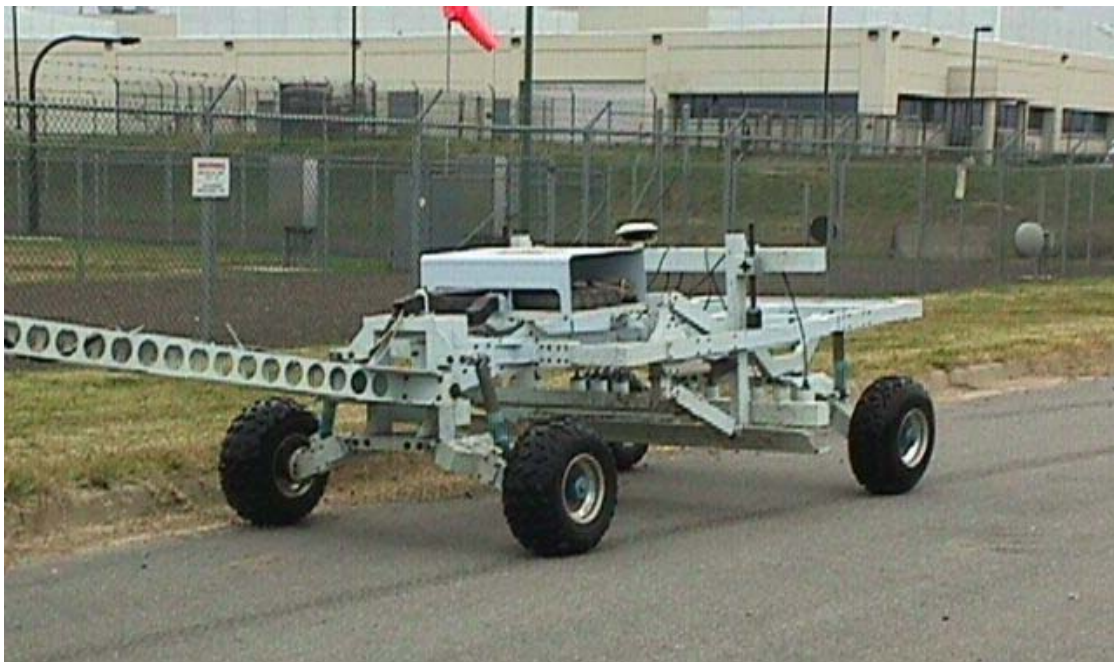
Figure D-7. MTADS Magnetometer Array
